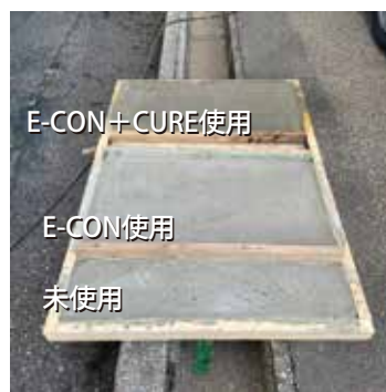
E-CON 使用により打設～初期水和反応時の温度上昇を抑えます。
